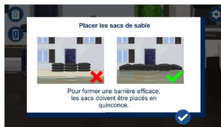
« Placer les sacs de sable » (niveau 2-7)
