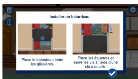
« Installer un batardeau » (niveau 2-5)
